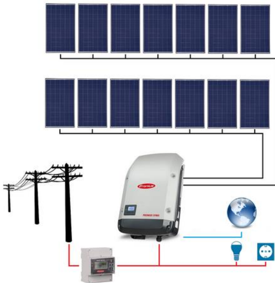
Fig. 11 - Schema de principiu sistem "on-grid" - fara acumulatori
